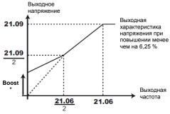
\* Если было выбрано фиксированное усиление, **05.14** = LINEAR V TO F (2), значение усиления задается через **05.15.** Данный параметр эквивалентен **05.09** в двигателе **1**.
